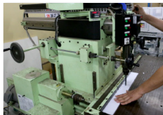
ツインセットドリルセッター 横からの穴加工、タップ加工が可能
